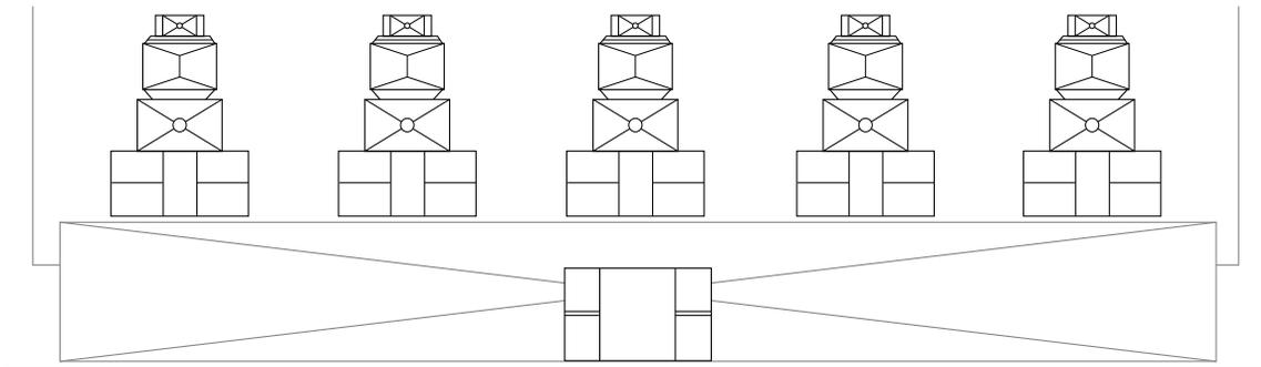
**COLLOCAZIONE DI DUE SUBWOOFER PRESSO LA PARETE/IL PAVIMENTO (ANGOLO DI RADIAZIONE PARI A "PI")**
