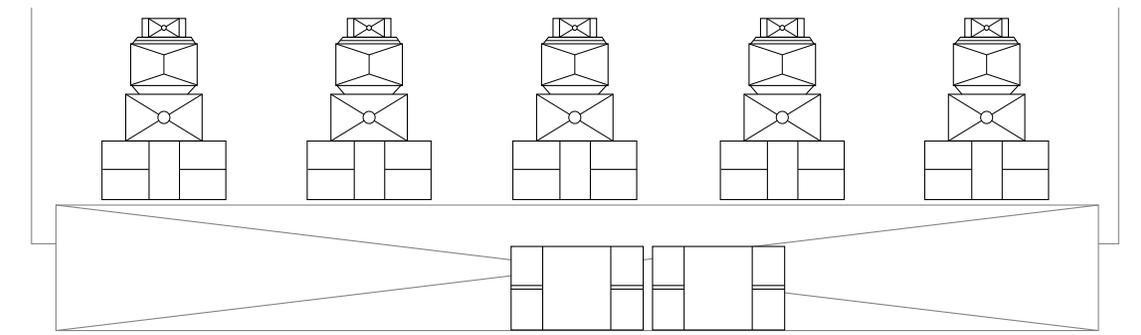
**POSICIONAMENTO DE SUBWOOFERS QUATRO EM 1/4 DE ESPAÇO EM PISO/PAREDE**
